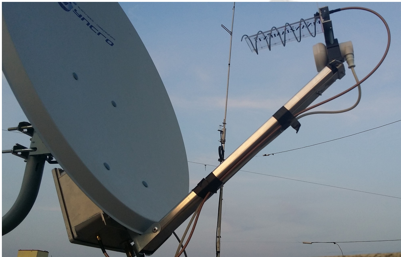
La parabola completa, con doppio illuminatore e, dietro, la scatola stagna che contiene up converter e amplificatore
