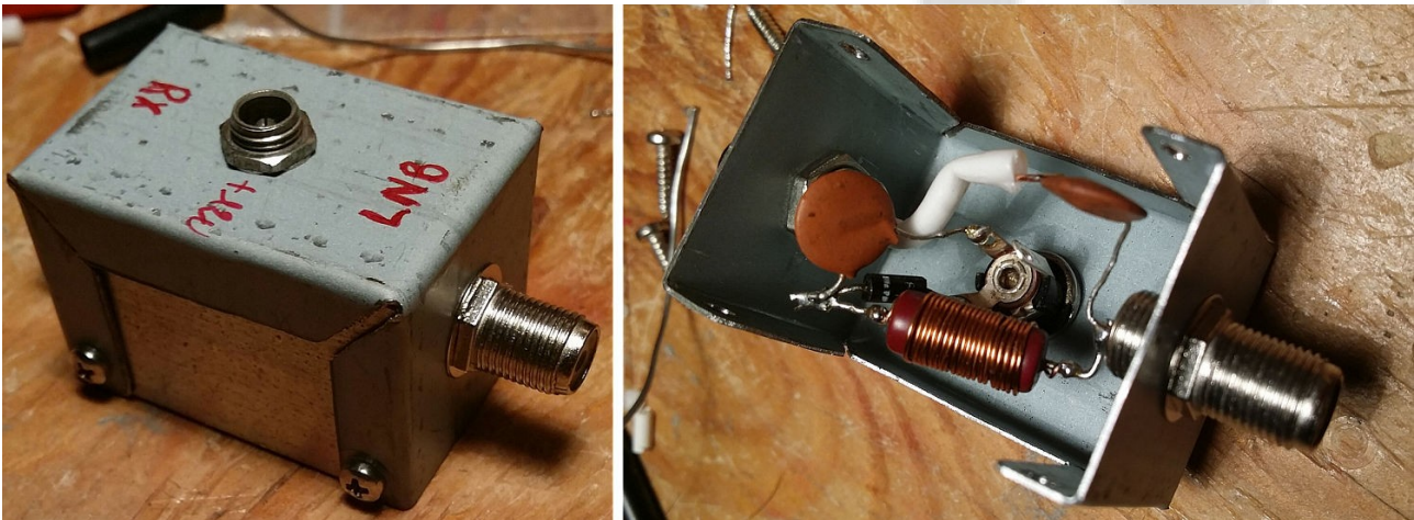
Il bias tee completo e pronto per il collegamento, realizzato con un pezzo di quadrello
