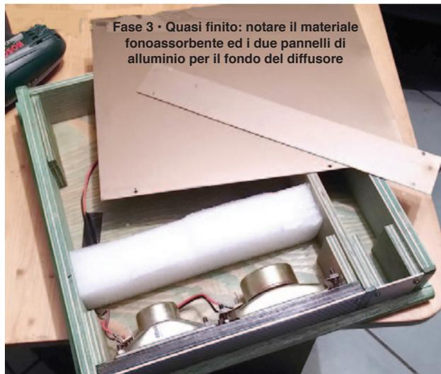
Fase 3 • Quasi finito: notare il materiale fonoassorbente ed i due pannelli di alluminio per il fondo del diffusore
